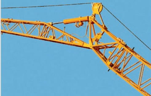
Гидравлически переставляемый откидной удлинитель (0° - 40°)
