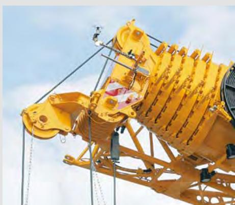
Гидравлическое монтажное приспособление для установки откидного удлинителя управляемое при помощи БТТ
