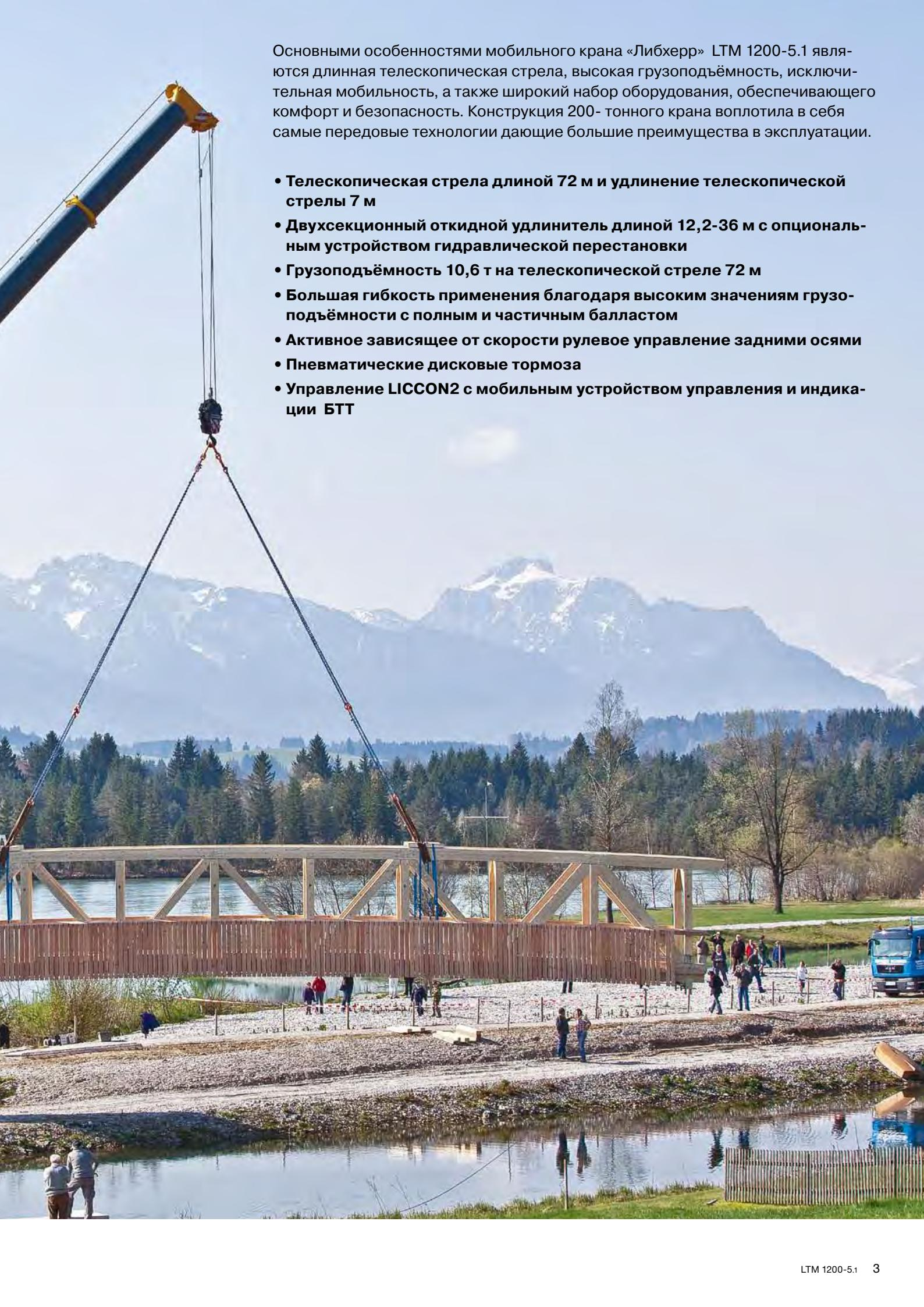
Основными особенностями мобильного крана «Либхерр» LTM 1200-5.1 являются длинная телескопическая стрела, высокая грузоподъёмность, исключительная мобильность, а также широкий набор оборудования, обеспечивающего комфорт и безопасность. Конструкция 200-тонного крана воплотила в себя самые передовые технологии дающие большие преимущества в эксплуатации.
