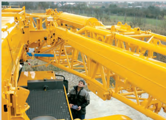
Гидравлическое монтажное приспособление для установки откидного удлинителя при помощи ВТТ
