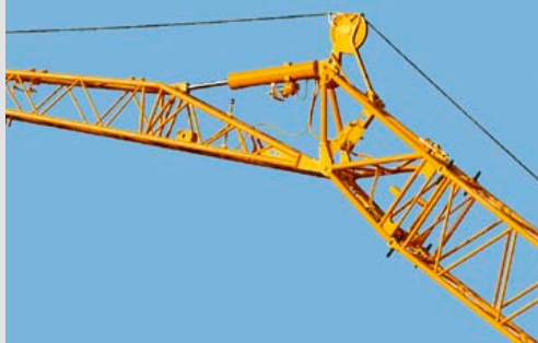
Гидравлически переставляемый откидной удлинитель (0° - 40°)
