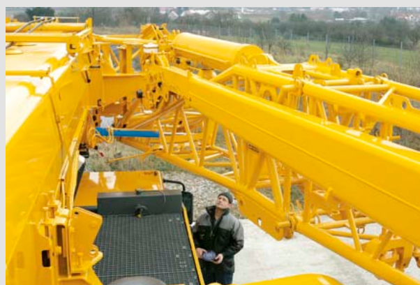
Гидравлическое монтажное приспособление для установки откидного удлинителя при помощи БТТ
