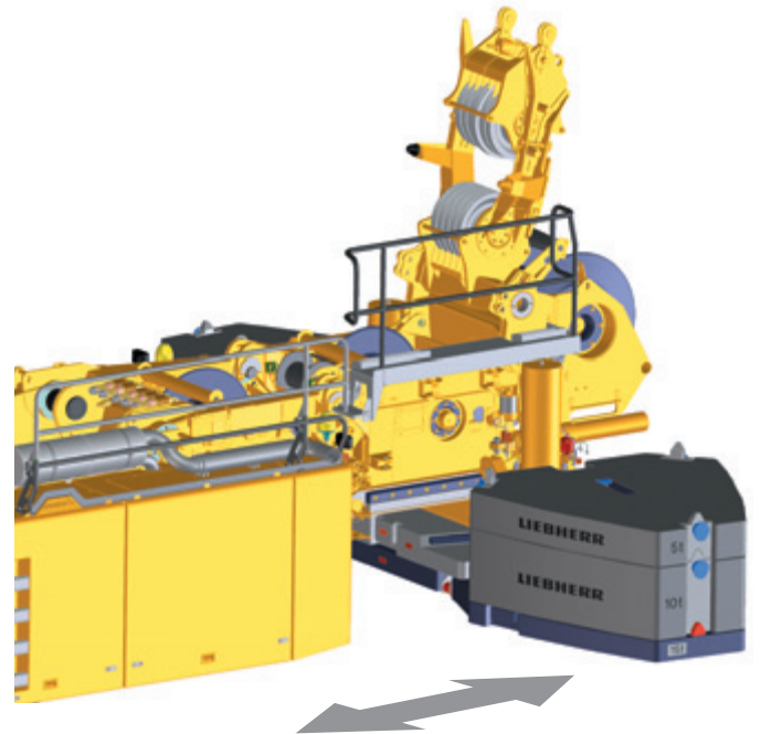
В режиме работы с качающимся удлинителем, радиус закругления 5,6 м или 6,6 м
